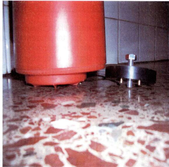
Demonstrationsbeispiel Pumpe mit integriertem Flachsauger und rechts daneben der Steuerungssensor
