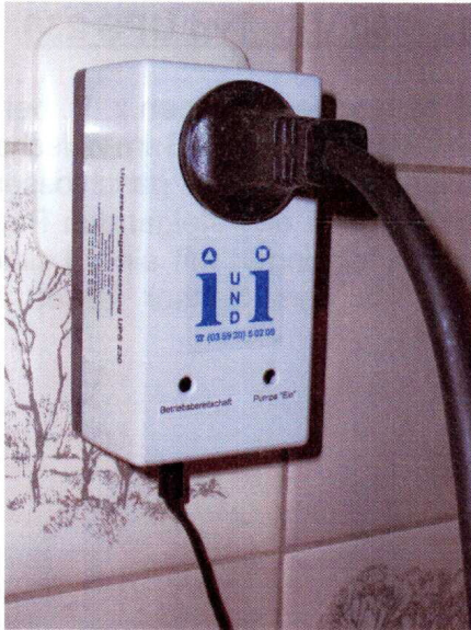
Das betriebsbereite Steuergerät mit Anschlusskabel der Pumpe
